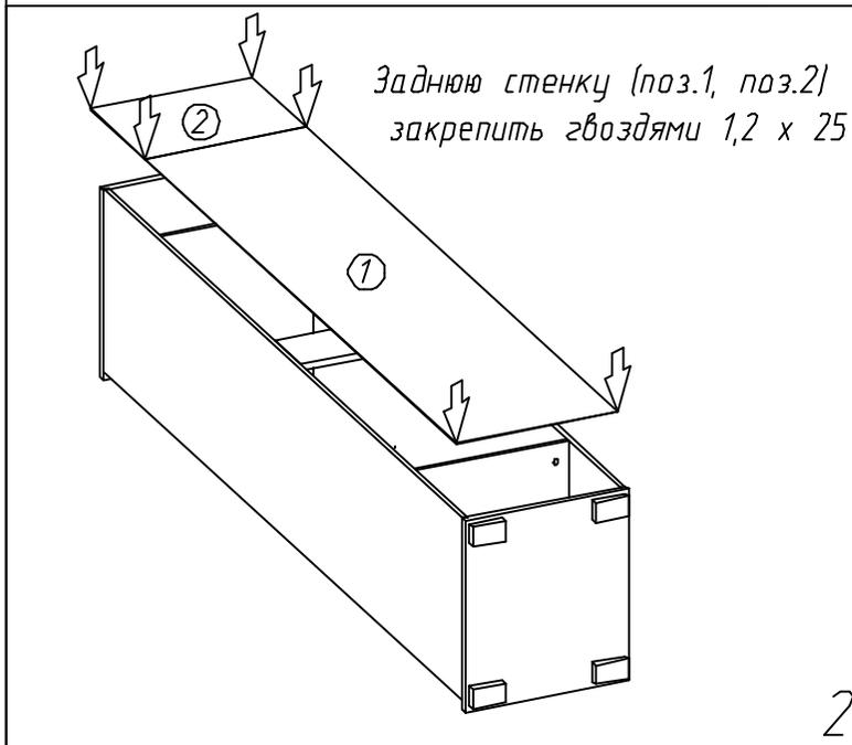
Заднюю стенку (поз.1, поз.2)
