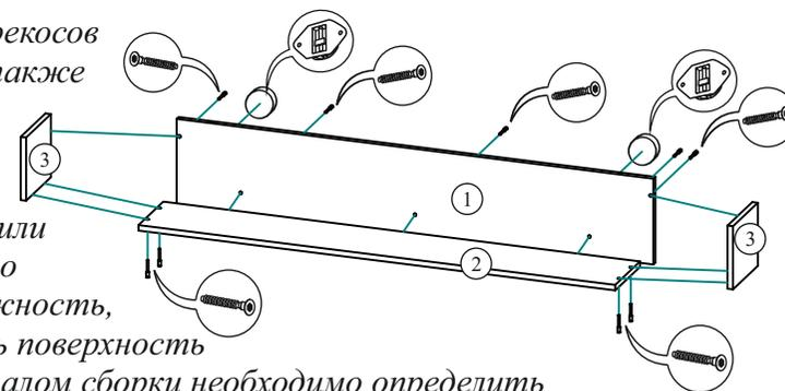
2. Вначале крепим евроинтами заднюю стенку 1 к полке 2, к ним крепим боковины 3, вставляем заглушки в видимые евроинты. Точно размечаем и сверлим в стене отверстия, вставляем дюбеля, вкручиваем саморезы из комплекта навеса регулируемого. Вставляем эксцентрик в отверстия на задней стенке 1. Навешиваем полку на саморезы и выравняем её по уровню регулировочными винтами через отверстия в верхнем торце задней стенки 1.
