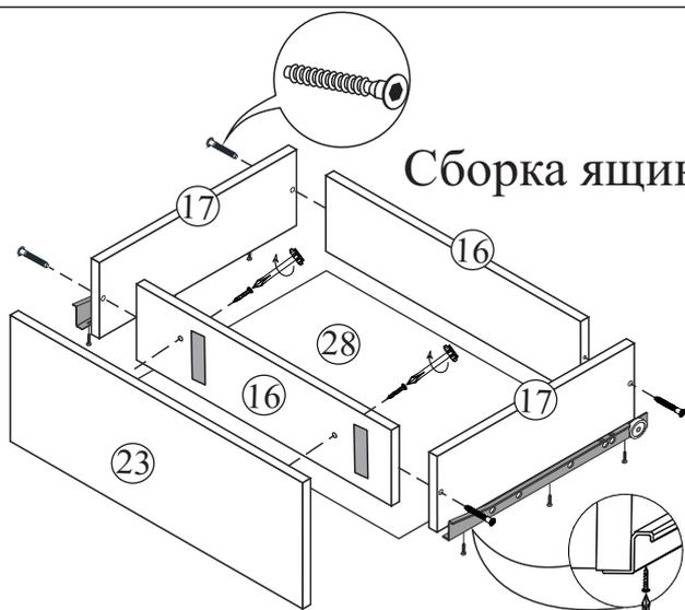
Фасад ящика устанавливается по месту. Крепится шурупами 4x30.
