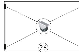
Выкатные ролики (27) крепятся с нижней стороны ящика при помощи шурупов 4x16
