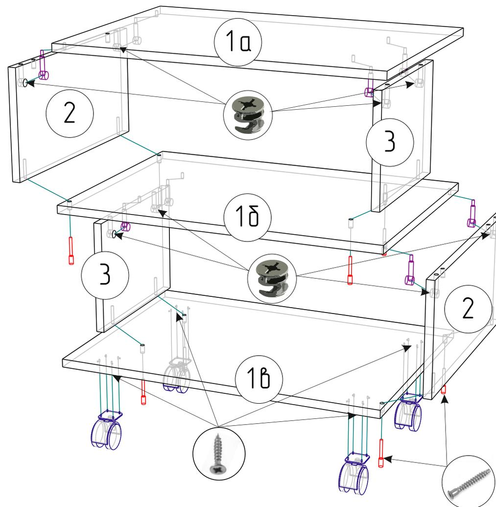
Соедините между собой все детали изделия при помощи евровинтов и эксцентриковой стяжки. (См. рис. 1)
