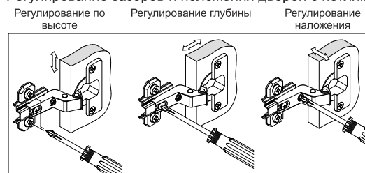
Регулирование зазоров и положения дверей с петлями
