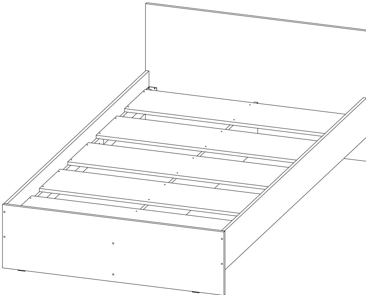
Кровать должна использоваться по назначению. Прыжки, падение, хождение по кровати не допускается - приведет к поломке крышек (поз. 5). Кровать эксплуатировать только с пружинным матрасом высотой 150-200 мм. Нагрузка на спальное место до 200 кг.
