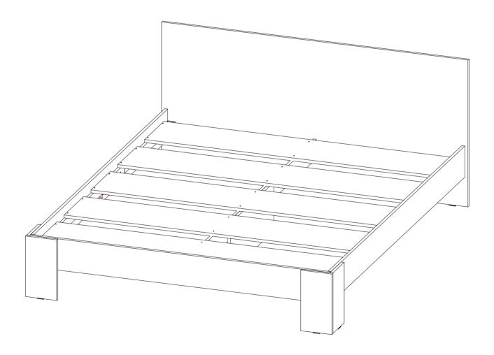
Кровать должна использоваться по назначению. Прыжки, падение, хождение по кровати не допускается - приведет к поломке крышек (поз. 5). Кровать эксплуатировать только с пружинным матрасом высотой 150-200 мм. Нагрузка на спальное место до 180 кг.
