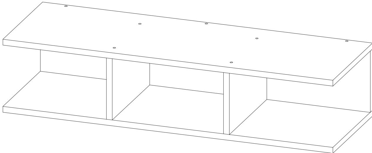
Нагрузка - не более 5кг при равномерно распределённых статичных нагрузках.
