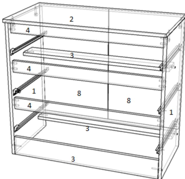
К детали 1 шурупами 3,5\*16 привернуть направляющие колесиком вперед. Прибить гвоздями подпятник. В готовые отверстия вставить шкант 8\*30. Евровинтами скрепить детали 1 и 3 предварительно установить планку 4 на шканты. Ввернуть шток эксцентрика в деталь 2 и скрепить крышку с боковинами замком эксцентрика.
