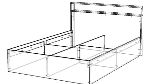
Прибить подпятник к деталям 1, 3, 4 и 5. Евровинтами скрепить детали 1, 3, 4, 5, 7, 8, 10, 11 и 12 (сначала крепиться деталь 8, а потом 7) как показано на рисунке. Шурупами 4\*30 привернуть планки 2 к деталям 1 на 40 мм от верха. Установить ламели держатели на ламели, равномерно разместить ламели на планках 2 и детали 3, привернуть шурупами 3,5\*16. Установить заглушки на евровинты.
