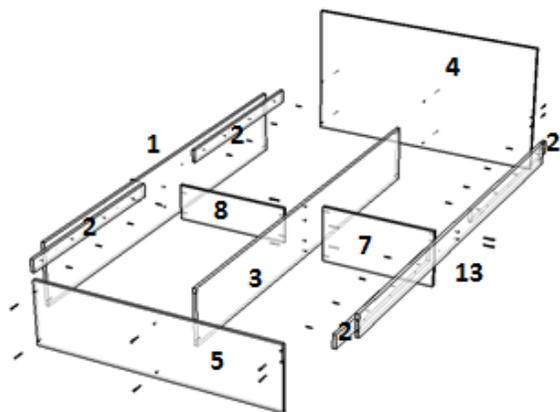
детали 1, 3, 4, 5, 7, 8 и 13 ( сначала крепиться деталь 8, а потом 7 ) как показано на рисунке. Шурупами 4\*30 привернуть планки 2 к деталям 1
