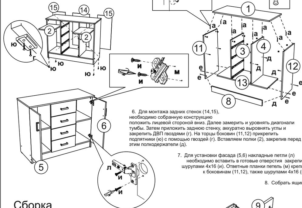
6. Для монтажа задних стенок (14,15), необходимо собранную конструкцию положить лицевой стороной вниз. Далее измерить и уровнять диагонали тумбы. Затем приложить заднюю стенку, аккуратно выровнять углы и закрепить ДВП гвоздями (г). На торцы боковин (11,12) прикрепить подпятники (ю) с помощью гвоздей (г). Вставляем полки (2), закрепив перед этим полкодержатели (д).
