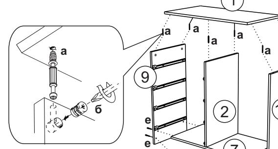
5. Боковины (9,2,10) крепим с крышкой (1) с помощью эксцентриковых стяжек (а,б).
