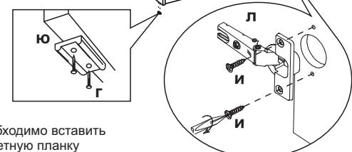
7. Для установки фасада (3), накладные петли (л), необходимо вставить в готовые отверстия и закрепить шурупами 4x16 (и). Ответную планку петли (м) крепим к боковине (10), также шурупом 4x16 (и).
