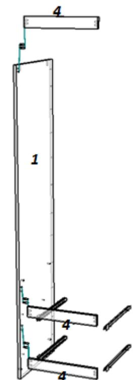
Шурупами 3,5\*16 привернуть направляющие к деталям 1. В готовые отверстия детали 1 вставить шканты. Евровинтами скрепить детали 1, 2, 3 и 7 предварительно установить планки 4 на шканты. Прибить ЛДВП 11 к тыльной стороне каркаса измерив диагональ изделия (диагональ должна быть одинаковой). Прибить подпятники к деталям 1.
