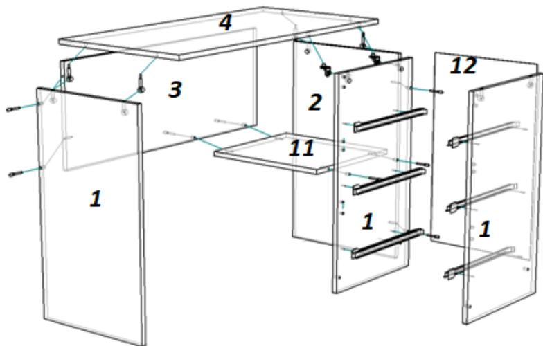
Шурупами 3,5\*16 привернуть направляющие к деталям 1 в готовые наметки. Скрепить евровинтами детали 1, 2, 3 и 11. Шурупами 3,5\*16 привернуть уголок к детали 1 для крепления детали 4. Евровинтами скрепить детали 1 (тумбы) с деталями 6 предварительно установив планки 7 на шканты и скрепить тумбу с деталями 2 и 11. В готовые отверстия деталей 4 и 5 ввернуть шток эксцентрика и скрепить их замками с боковинами (деталь 4 привернуть шурупами к уголкам). Прибить ЛДВП 12 к тыльной стороне тумбы.
