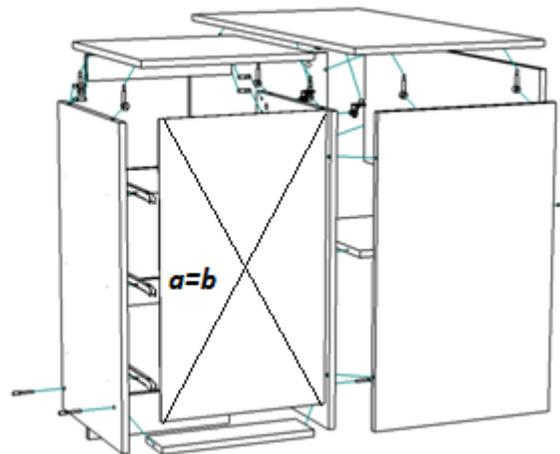
Евровинтами скрепить детали 8 и 9. В готовые отверстия детали 10 ввернуть шток эксцентрика и скрепить замками с деталями 8. Прибить ЛДВП 13 к деталям 8 и 9 предварительно вставив его в пропил фасада и измерив диагональ. Привернуть шурупами 3,5\*16 направляющие к деталям 8 и вкатить ящик в корпус стола.
