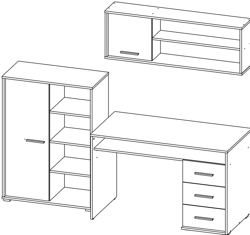
Нагрузка на полку не должна превышать 8 кг., при условии равномерно-распределённой статичной нагрузке. Максимальная нагрузка на шариковые направляющие до 15 кг. (нагрузка должна быть распределена по всей площади ящика).
