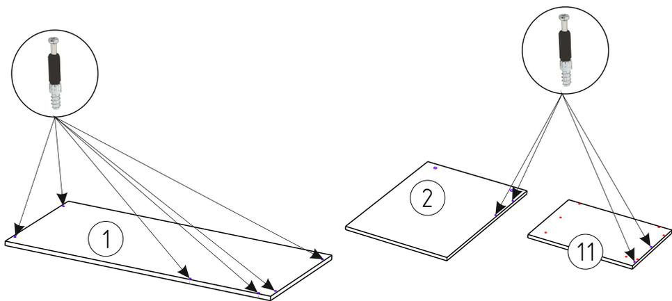
Теперь в отверстия на (дет. № 2; 3 и 10) вставьте эксцентрик. (См. Рис. 4)
