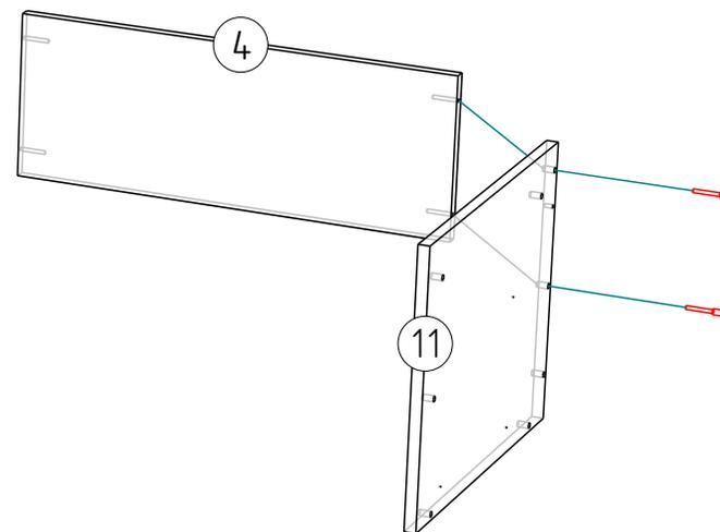
Соедините между собой (дет. № 3; 4; 5; 6; 10 и 11) при помощи евровинтов и эксцентриковой стяжки. (См. рис. 6)
