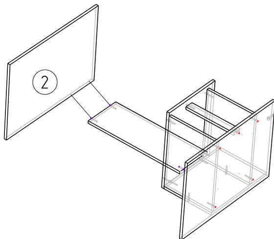
При помощи эксцентриков закрепите столешницу (дет. № 1) к собранному корпусу. (См. рис. 8)
