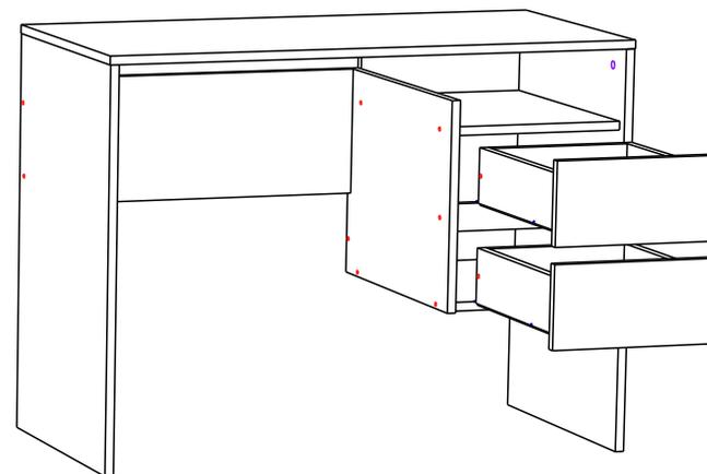
При помощи евровинтов 6x50 соедините между собой собранный корпус и (дет. № 2). (См. рис. 7)
