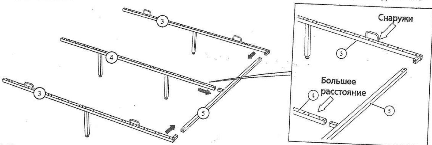
3. Соединить согласно схемы, через сквозные отверстия в царгах (3), (4), (5) винтом M8x40 (7) с шайбой (9) и гайкой M8 (8) с шайбой (9) царги. **ВАЖНО:** все винтовые соединения сначала необходимо «наживить», обтяжка производиться после установки всех деталей.
