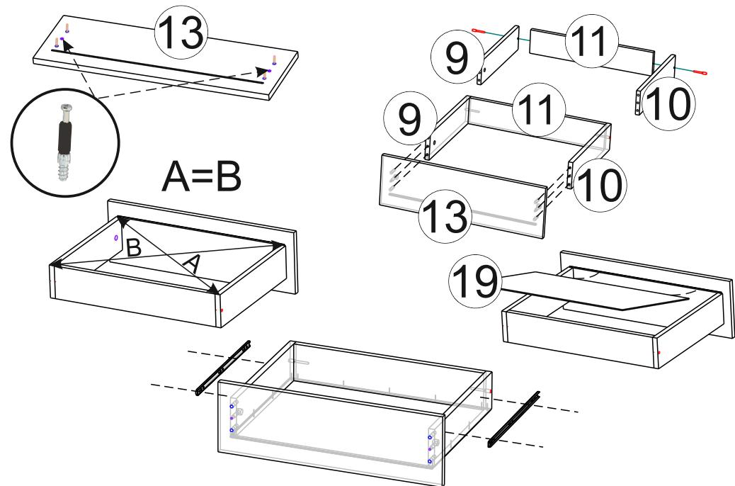
В конце сборки повесьте створки. Поставьте полки на полкодержатели. Отрегулируйте зазоры. Поставьте заглушки. Приверните ручку. Повесьте скалку на скалкодержатели. Вставьте ящик на направляющие. (См. Рис. 8)
