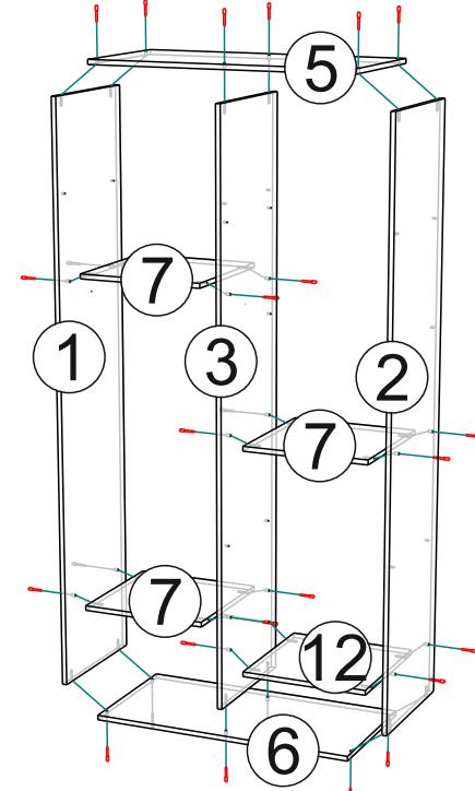
Переверните собранный шкаф. Замерьте диагональ. Размеры должны совпадать. После гвоздями 2x20 с шагом в 10 см прибейте заднюю стенку из ЛДВП (дет. № 15; 16; 17 и 18). (См. рис. 6)
