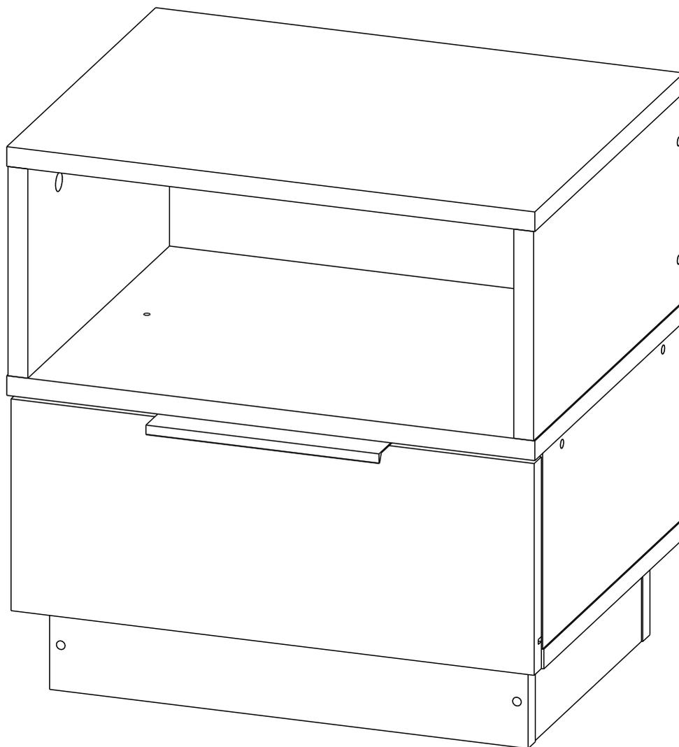
Нагрузка на шариковые направляющие до 8кг. при равномерно распределённой нагрузке.
