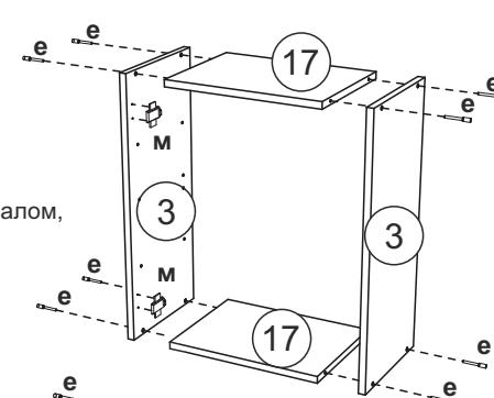
2. Производим сборку корпуса 400 мм. Боковины (3) соединяют вязкими (17) используя евровинт (е).
