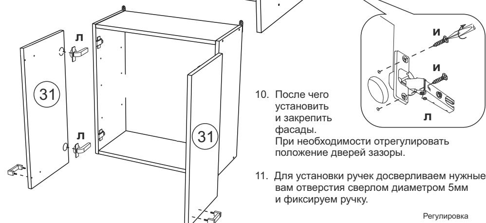
10. После чего установить и закрепить фасады. При необходимости отрегулировать положение дверей зазоры.
