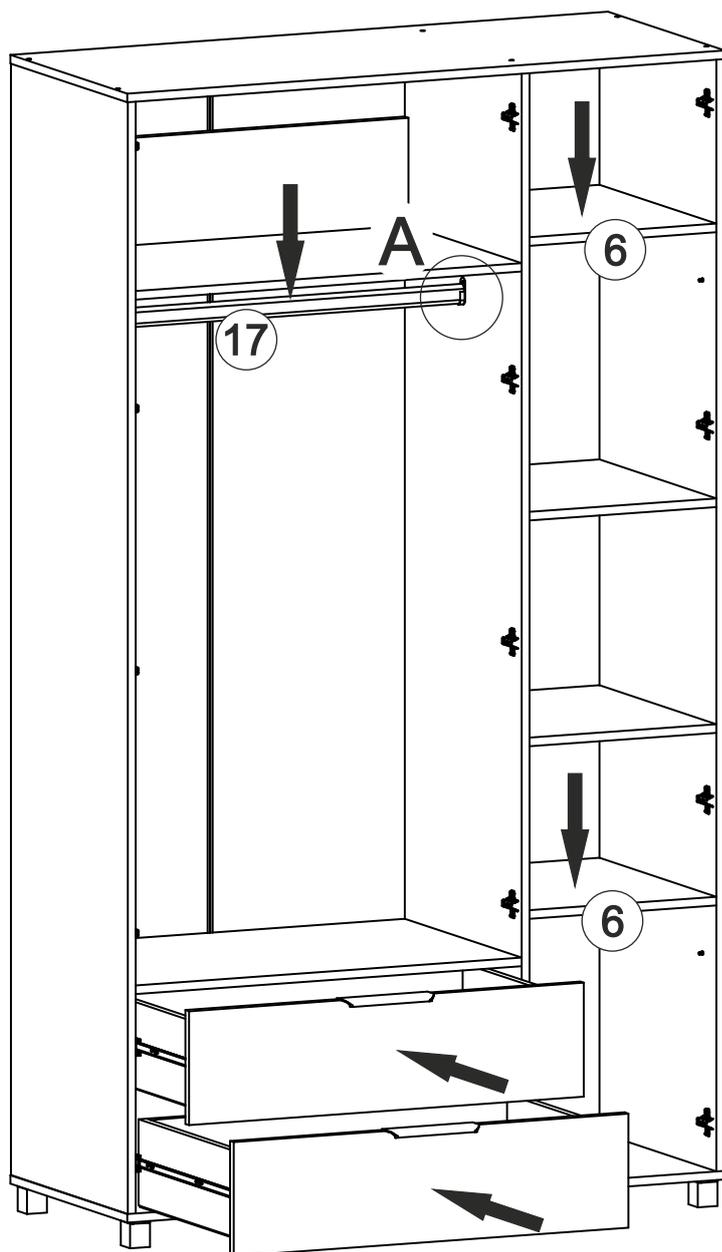
Установить полки поз. 6 и штангу поз. 17. Установить ящики по направляющим в корпус шкафа.
