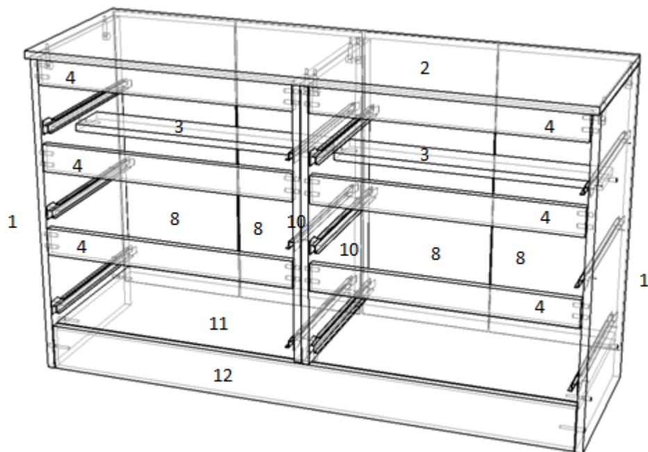
К детали 1 и 10 шурупами 3,5\*16 привернуть направляющие колесиком вперед. Прибить гвоздями подпятник к детали 1. В готовые отверстия деталей 1 и 10 вставить шкант 8\*30. Евровинтами скрепить детали 1, 3, 10, 11 и 12 предварительно установить планку 4 на шканты. Ввернуть шток эксцентрика в деталь 2 и скрепить крышку с боковинами 1 и 10 замком эксцентрика.
