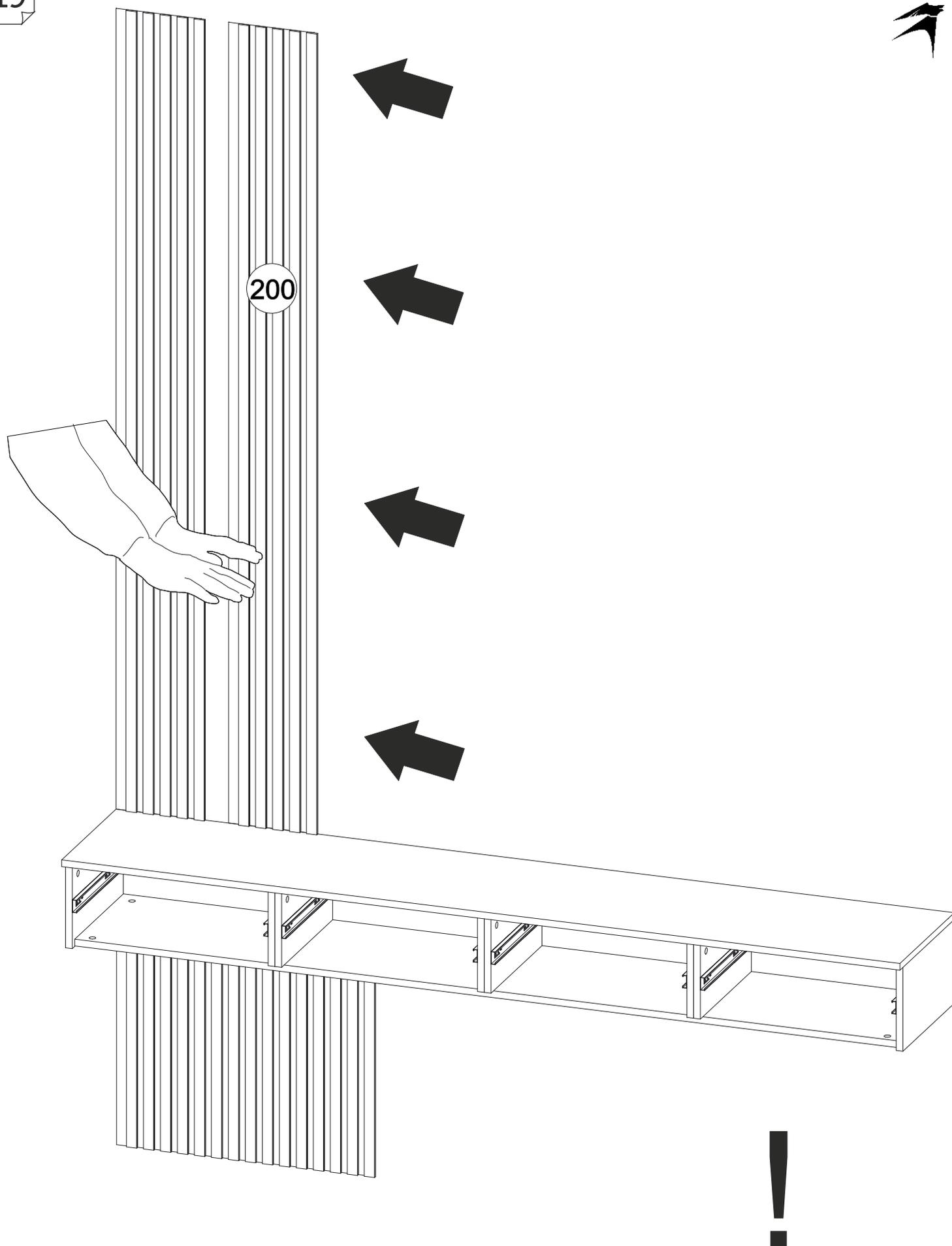
Выдержать согласно инструкции жидких гвоздей
