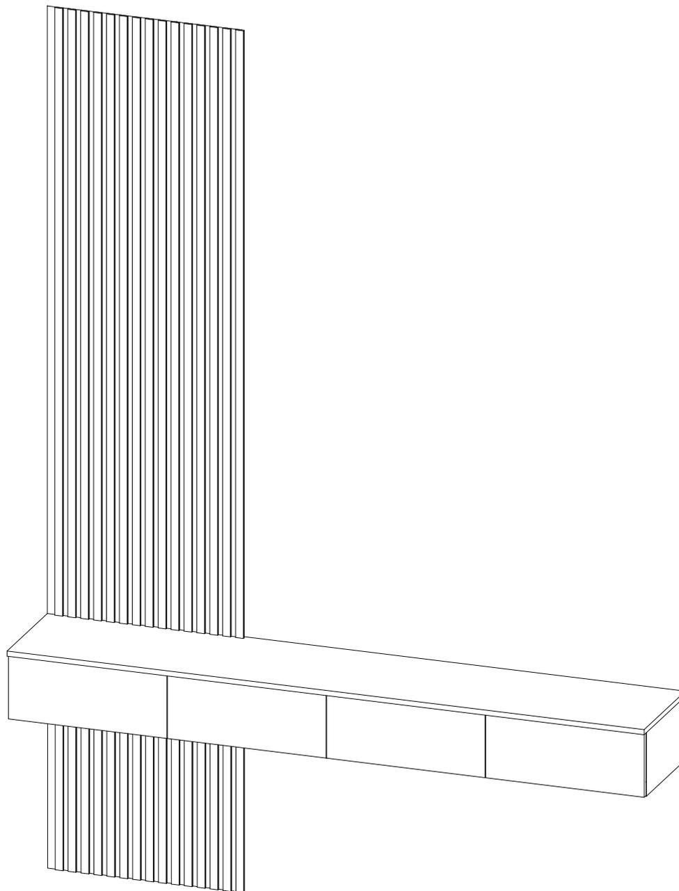
Нагрузка на ящики до 10кг. Нагрузка на тумбу до 50кг.
