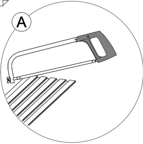
Отмерить нужный размер в зависимости высоты от тумбы до потолка и отрезать панели ножовкой по металлу с лицевой стороны.
