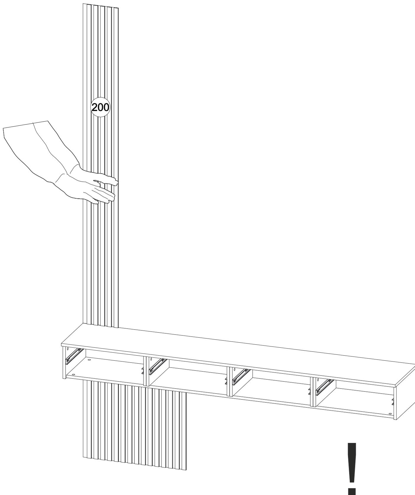
Выдержать согласно инструкции жидких гвоздей
