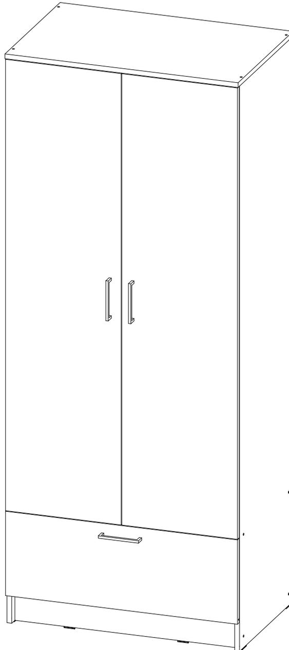
Максимальная нагрузка на роликовые направляющие до 10 кг (при равномерно распределённой нагрузке). Шкаф **ОБЯЗАТЕЛЬНО** крепить к стене.
