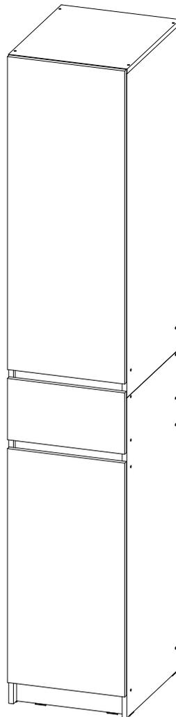
**Нагрузка на шариковые направляющие до 8кг. при равномерно распределённой нагрузке.**
