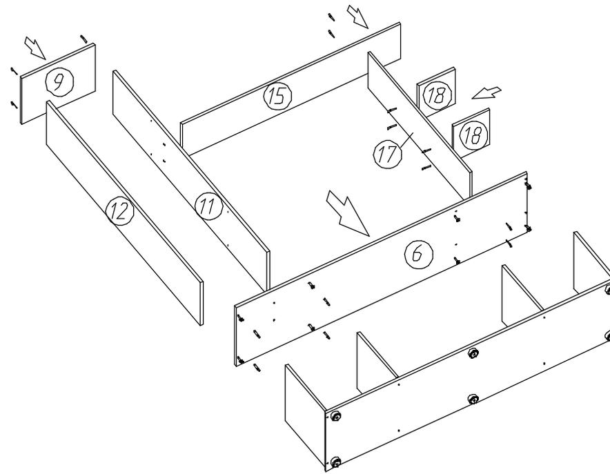
После выполнения пункта сборки "2" необходимо к крышке поз. 6 прикрутить дюбели эксцентриковой стяжки и закрепить на крышке детали верхней надстройки поз.11, поз.12, поз.9, поз.17, поз.15 и поз.18. Затем установить данную сборку на сборку второго этапа. Далее выровнять диагонали тумбы закрепить заднюю стенку поз.28 так, чтобы ДВП наполовину закрывало крышку поз.6 и дальше выровнив (проверив) диагонали надстройки пенала так же закрепить заднюю стенку поз.30 надстройки пенала.
