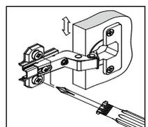
Регулировка по глубине
