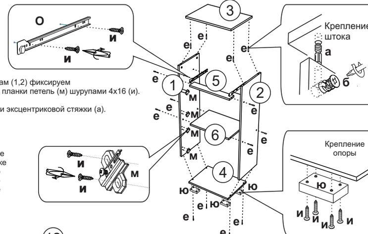
Схема крепления соединительного элемента
