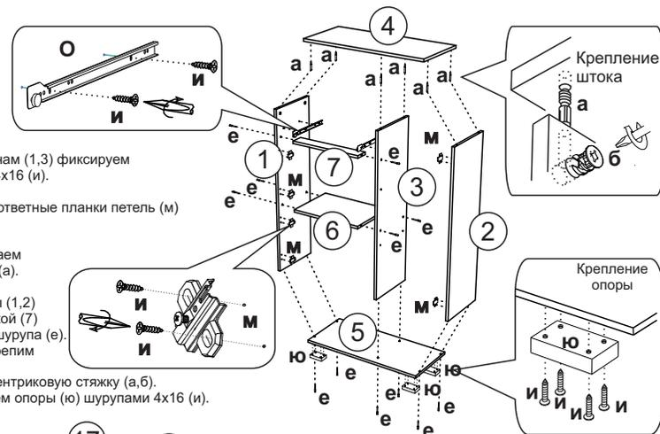
Схема крепления соединительного элемента
