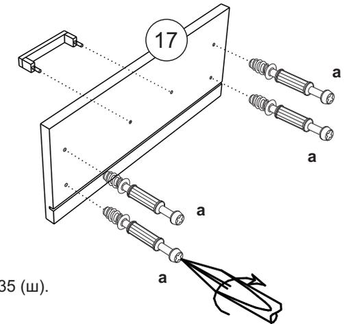
1. Шток эксцентриковой стяжки (а) крепим к фасаду ящика (17).
