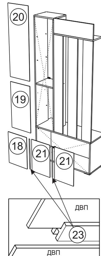
Схема крепления соединительного элемента
