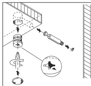
Установка стяжки секционной
