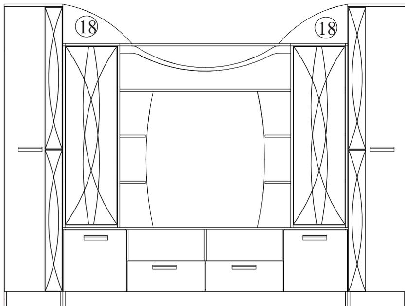
Для соединения пеналов или шкафов с центральной секцией необходимо самостоятельно просверлить в боковине тумбы и пеналов/шкафов два отверстия диаметром 5 мм. В боковине пеналов досверлить технологических отверстия диаметром 8 мм до сквозных. Установить задние щиты 18 с помощью евровинтов.
