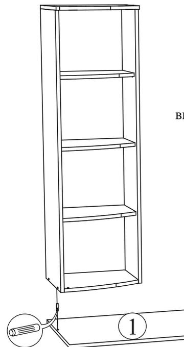
Для правильного открывания ящиков, необходимо выровнять диагонали каркаса ящика (Рис.1) и только потом прибить ЛДВП не нарушая диагонали.
