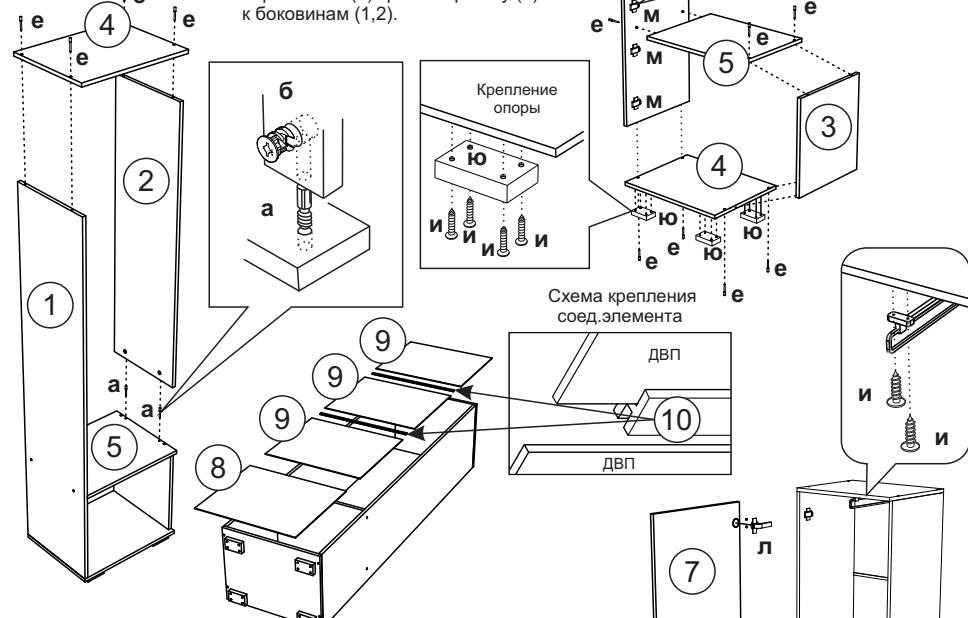
4. Для крепления задних стенок (8,9) необходимо собранную конструкцию положить лицевой стороной вниз. Замерить и уровнять диагональ. После этого приложить детали и выровнять углы. Задние стенки (9) соединить бруском (10). После выверки закрепить ДВП гвоздями (г).
